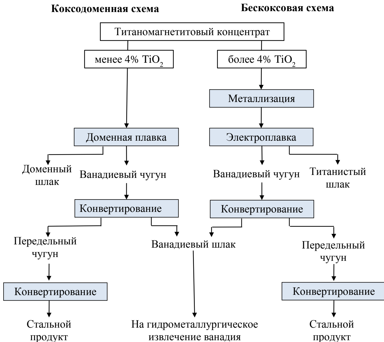
Рисунок 5 – Принципиальные технологические схемы коксодоменной и бескоксовой переработки титаномагнетитовых концентратов.
